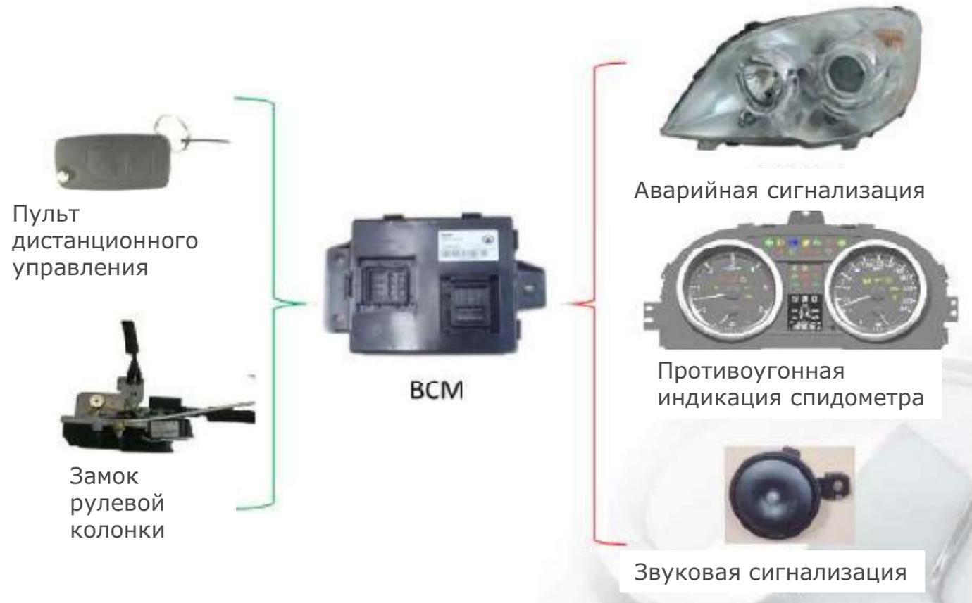
Центральная система управления 580VCM имеет функцию открытия и закрытия, автоматический возврат к функции защиты, функцию блокировки движения, функцию блокировки блокировки, дистанционное управление и функцию отключения детонации подушки безопасности.
