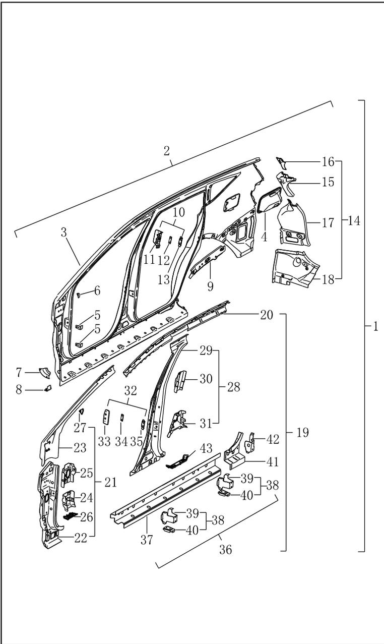
**Сварочный узел наружной обшивки боковой панели (справа)**
