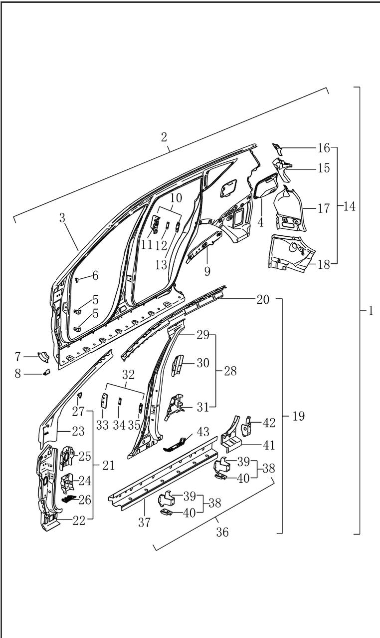
**Сварочный узел наружной обшивки боковой панели (справа)**
