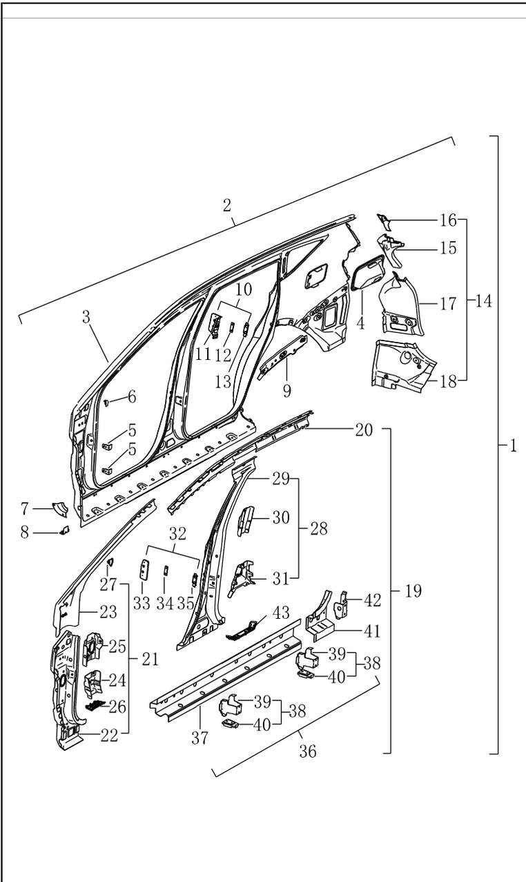
**Сварочный узел наружной обшивки боковой панели (справа)**
